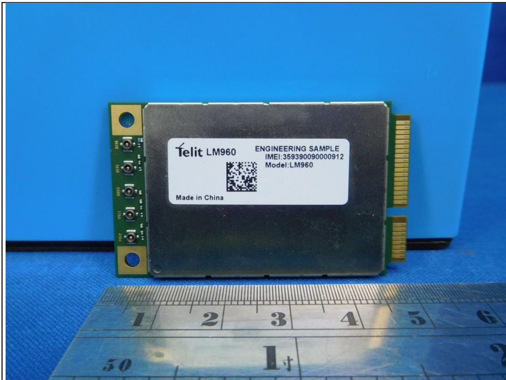
LTE module (Brand: Telit, Model: LM960)
