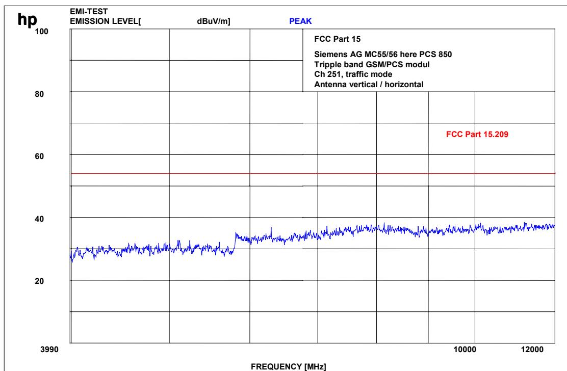
$f < 1 \text{ GHz}$  : RBW/VBW: 100 kHz       $f \geq 1 \text{ GHz}$  : RBW/VBW 1 MHz
