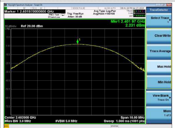
\pi/4 DQPSK (CH39)
