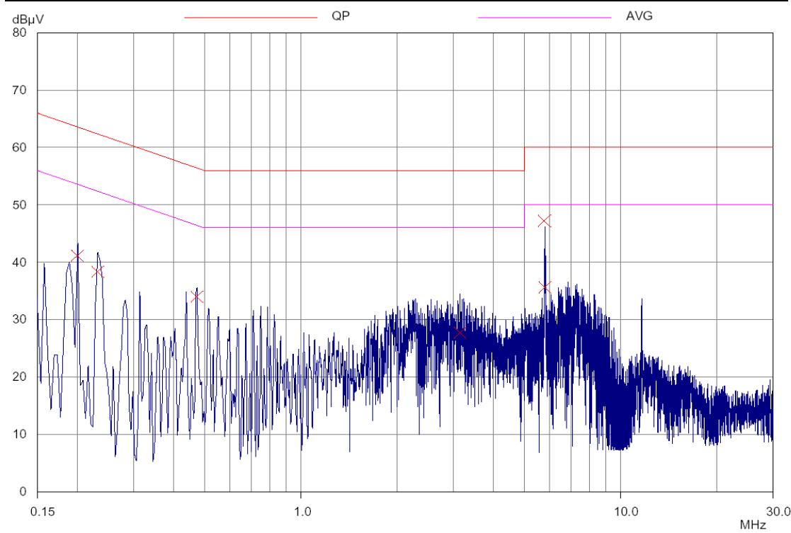
**B. Adaptor 2**Operation Mode : Handset Charge NeutralTest Date : Jun. 07, 2008 Temperature : 22 °C Humidity : 65 %
