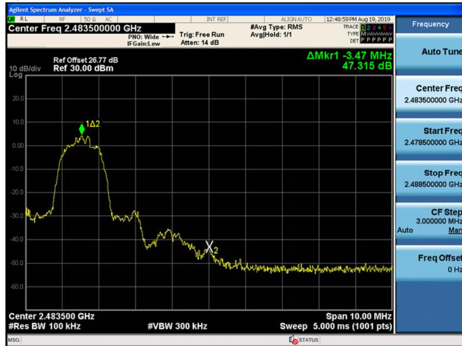
Test Plots without hopping ( $\pi/4$ DQPSK)
