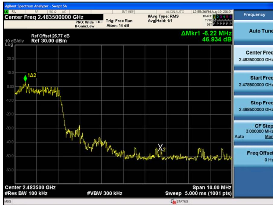
Test Plots with hopping ( $\pi/4$ DQPSK)
