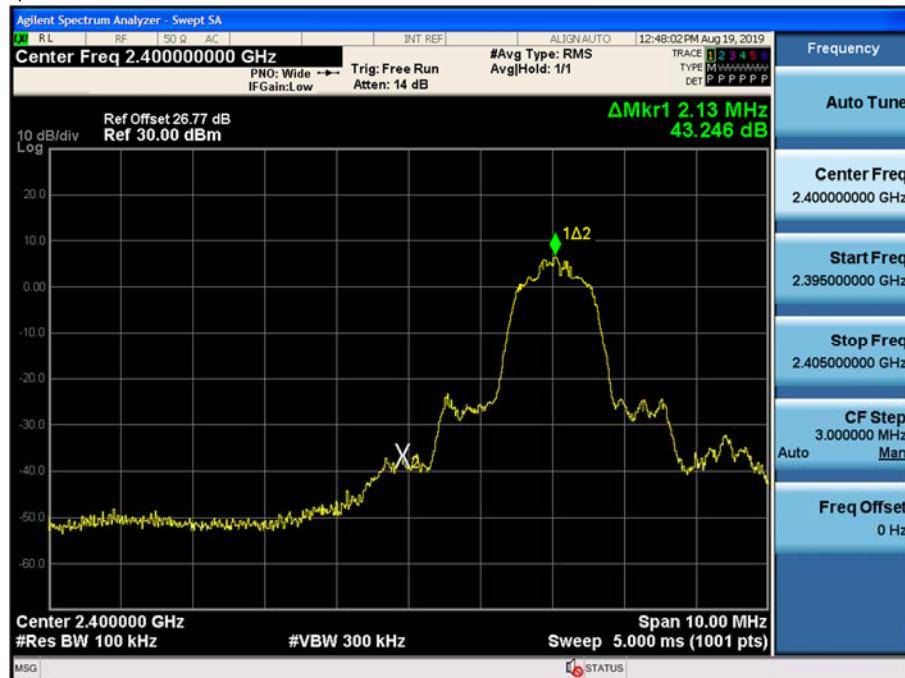
Test Plots without hopping ( $\pi/4$ DQPSK)
