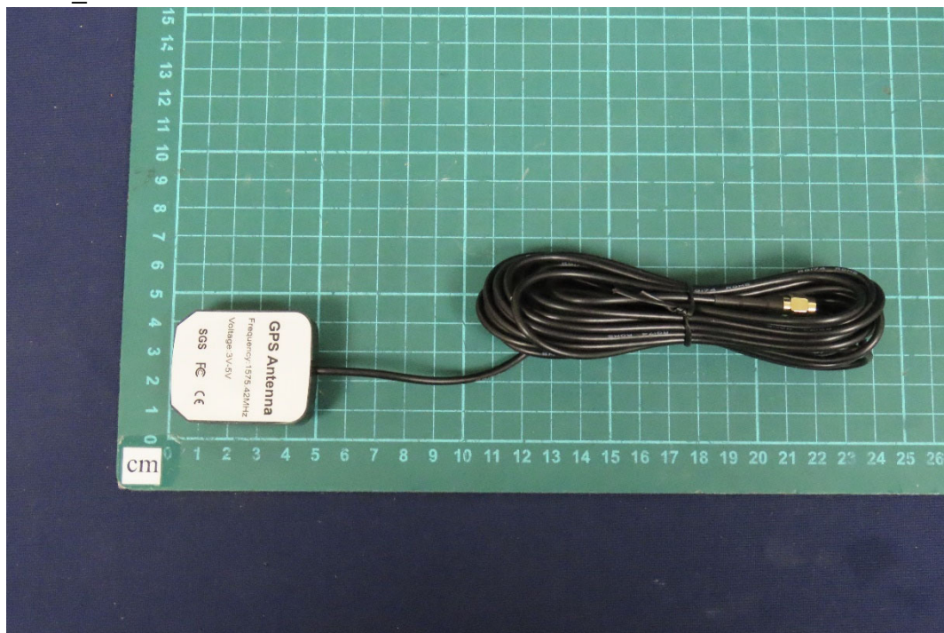
(8) EUT Photo_GPS antenna
