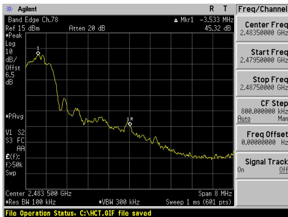
Test Plots without hopping ( $\pi/4$ DQPSK)
