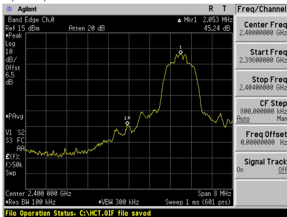
Test Plots without hopping ( $\pi/4$ DQPSK)
