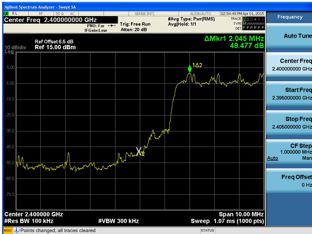
Test Plots with hopping ( $\pi/4$ DQPSK)
