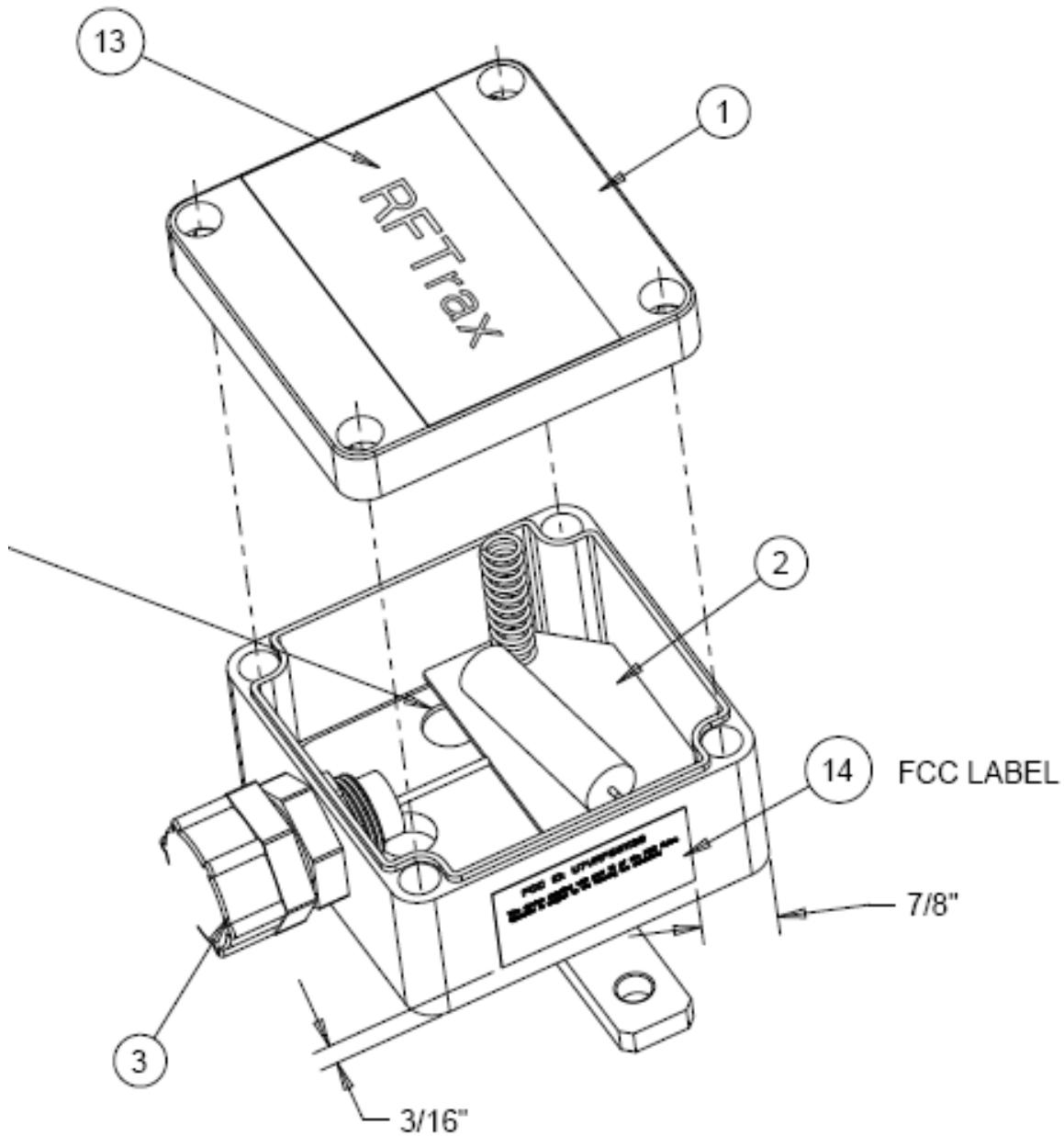
**SKETCH OF THE LOCATION OF FCC LABEL ON RF SWITCH TRANSMITTER**
