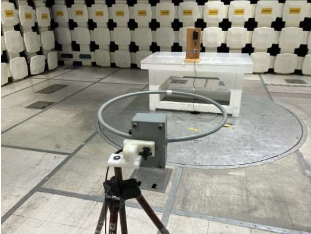
2.4 GHz BLE Test Setup (NTT – Push Button), 9 kHz – 30 MHz, Z-Axis
