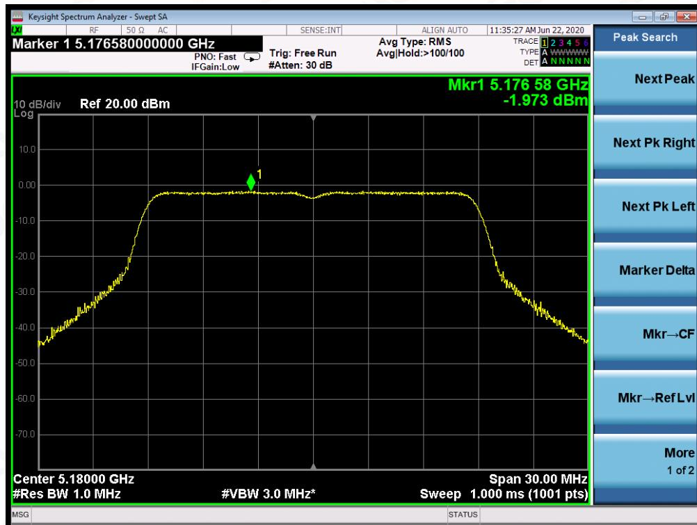
**TEST PLOT OF SPECTRAL DENSITY FOR 5200MHz**
