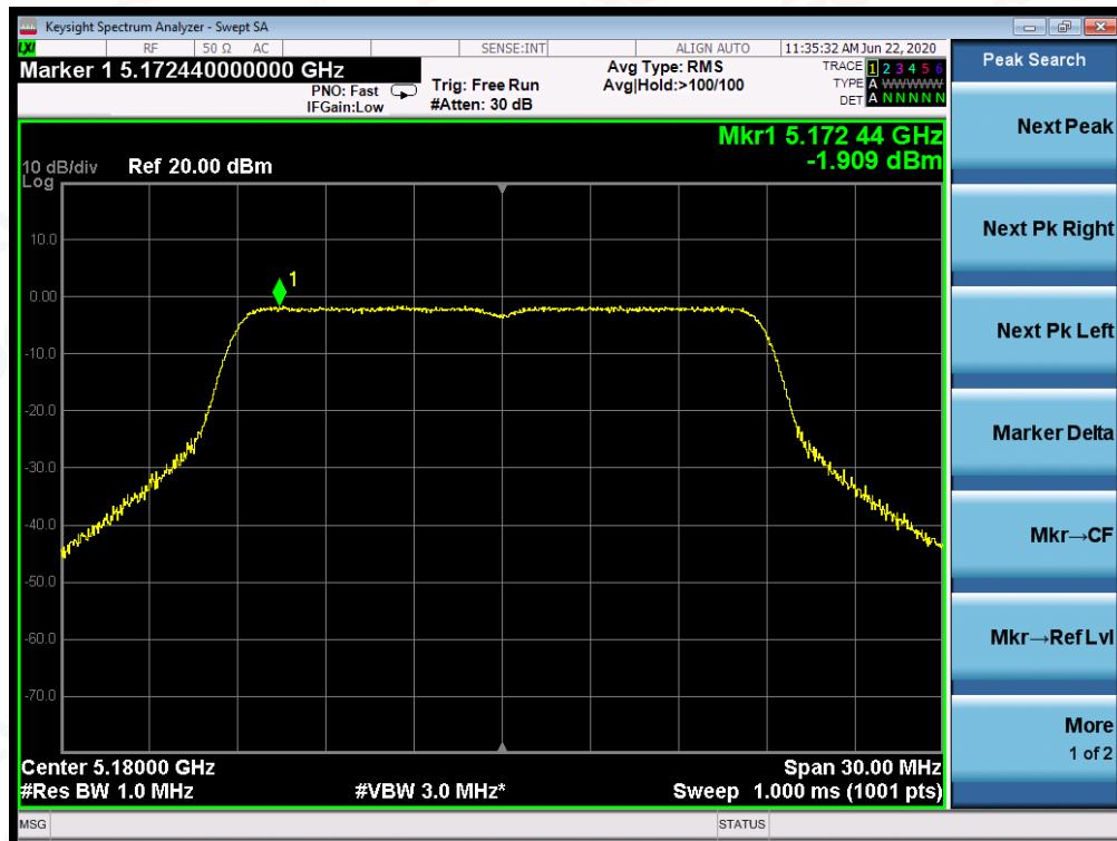
**TEST PLOT OF SPECTRAL DENSITY FOR 5200MHz**
