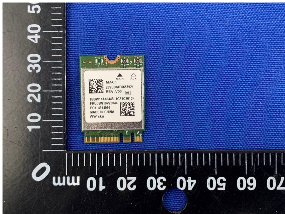
RF MODULE TOP VIEW-RTL8852BE
