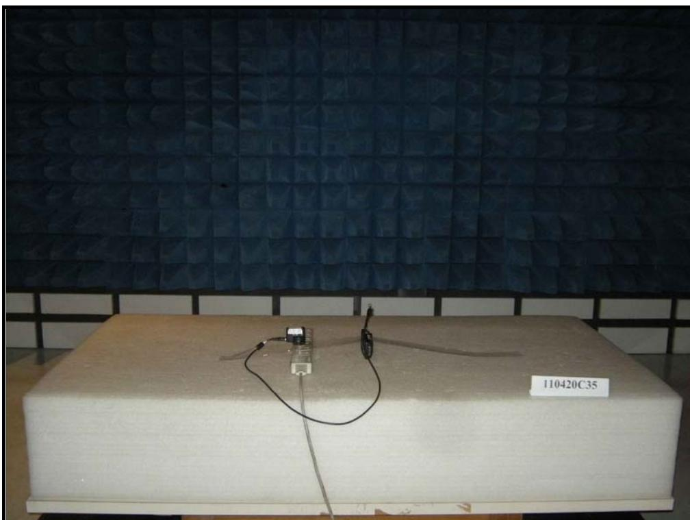
RADIATED EMISSION TEST (TEST MODE B)
