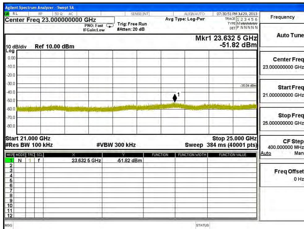
**Channel 11 (2462MHz) 30MHz -25GHz-Chain C**
