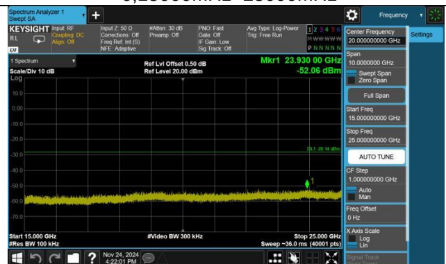
802.11n(HT20),2437MHz,Ant0,Plot 2,Band Edge
