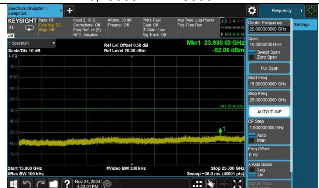
802.11n(HT20),2437MHz,Ant0,Plot 2,Band Edge
