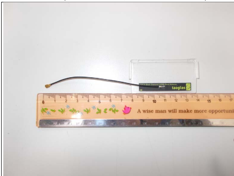
Antenna 4 (Brand: TAOGLAS ; Model: FXP74.07.0100A)
