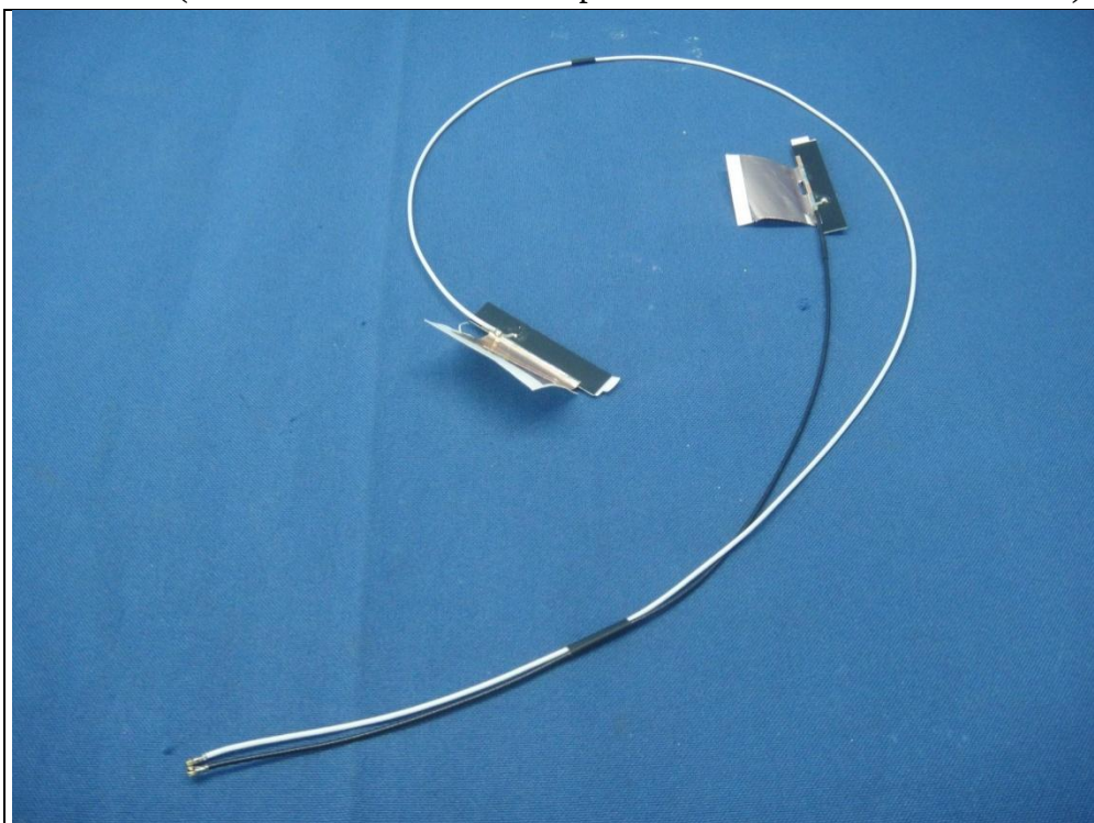
Antenna 3 (Brand: Wistron NeWeb Corporation / Model: 81EAAX15.G12)
