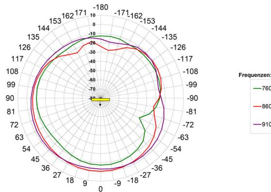
\* gemessen mit 0,6 m Kabel auf einer Massefläche von 300 mm x 300 mm
