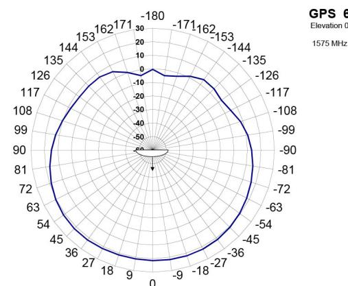
\* gemessen mit 0,6 m Kabel auf einer Massefläche von 300 mm x 300 mm
