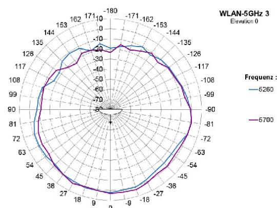
\* gemessen mit 0,6 m Kabel auf einer Massefläche von 300 mm x 300 mm
