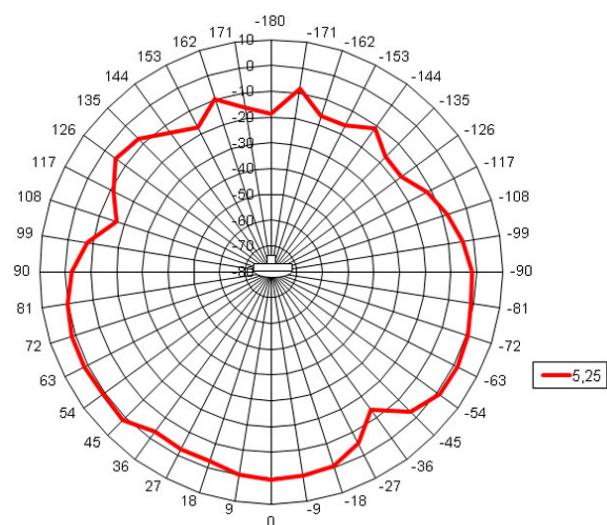
\* gemessen mit 0,6 m Kabel auf einer Massefläche von 300 mm x 300 mm
