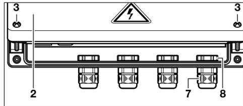
Entfernen Sie am spannungsfreien EXAConnect die Wartungsklappe **2**, indem Sie die unteren 2 kleinen Kreuzschlitzschrauben **3** herausdrehen. So gelangen Sie an die Klemmleiste **9**.
