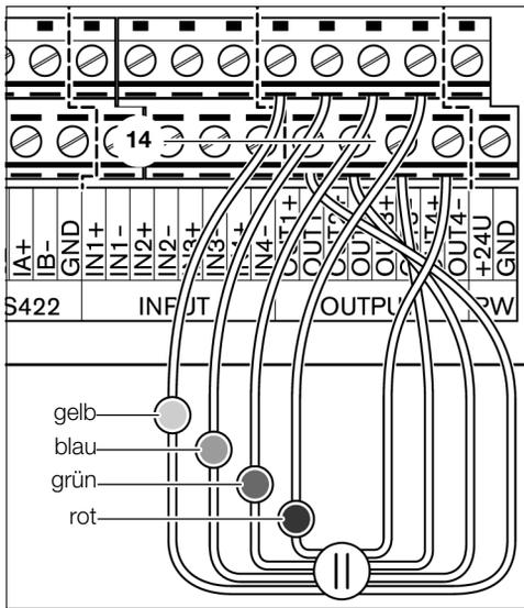
Führen Sie das Kabel der Signallampe durch die Öffnung des Anschlussstutzens **8** zum 24-V-Ausgang **14** auf der Klemmleiste. Der 24-V-Ausgang ist mit Optokopplern potenzialfrei für 24-V-Signale ausgelegt. Es können bis zu 3 A geschaltet werden.
