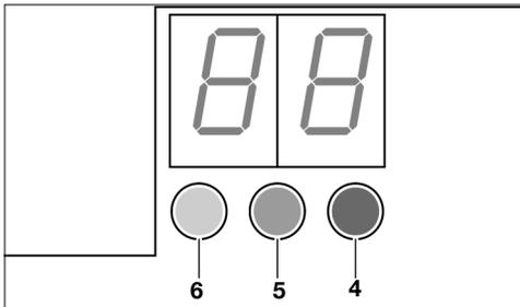
Die blaue LED-Anzeige **6** zeigt durch Dauerlicht mindestens eine bestehende Bluetooth®-Verbindung an.
