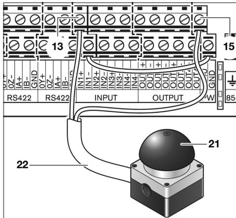
Verbinden Sie im EXAConnect eine Ader von der GND-Klemme des Gleichstromausgangs **15** mit der passenden „IN“-Klemme des 24-V-Eingangs **13**. Wenn Sie z. B. eine Ader vom Kabel **22** des Freigabe-Tasters an der „IN1+“-Klemme des 24-V-Eingangs **13** angeschlossen haben, dann müssen Sie die interne Ader an der „IN1“-Klemme anschließen.
