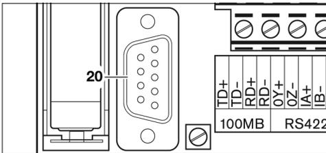
Die Baudrate der RS232-Schnittstelle ist fest auf 9600 Baud, 8 Datenbits, keine Parität, 1 Stoppbit (8N1) eingestellt. Die RS232-Schnittstelle verwendet keinerlei Handshake. Sie ist als DCE (Data Communication Equipment) und nicht potenzialfrei ausgeführt.
