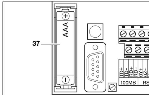
Entfernen Sie die alte Batterie **37** und setzen Sie eine neue Standard-Mikrozelle AAA ein.
