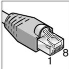
Messen Sie an dem verbliebenen Stecker des Twistedpair-Kabels, welche Farbe an welchem Pin liegt. Entnehmen Sie der nachfolgenden Tabelle, welche Adern Sie für den Anschluss am EXAConnect brauchen, und isolieren Sie die nicht benötigten Adern ab. Schließen Sie die verbliebenen Adern gemäß der Tabelle am Ethernet-Anschluss **10** der Klemmleiste **9** an. Schließen Sie die Schirmung des Twistedpair-Kabels an die Erdungsklemme **17** an.
