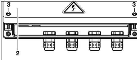
Entfernen Sie am spannungsfreien EXAConnectT die Wartungsklappe **2**, indem Sie die unteren 2 kleinen Kreuzschlitzschrauben **3** herausdrehen. So gelangen Sie an den Reset-Taster **39**.
