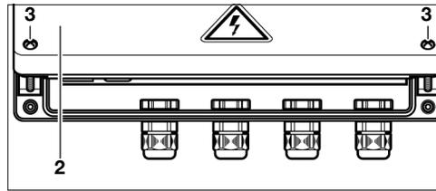
Entfernen Sie am spannungsfreien EXAConnect die Wartungsklappe **2**, indem Sie die unteren 2 kleinen Kreuzschlitzschrauben **3** herausdrehen. So gelangen Sie an die Pufferbatterie **37**.
