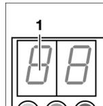
Der Systemzustand **34** meldet die Betriebsbereitschaft des Systems oder zeigt die Statuscodes (siehe *Statuscodes*) analog zu den im Display **1** der Basisstation gezeigten an. Liegen mehrere Statuscodes an, wechselt deren Anzeige im 2-Sekunden-Takt zyklisch.
