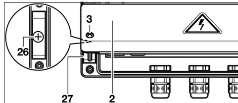
Zur Wandbefestigung des EXAConnect benötigen Sie zwei M4-Schrauben **26** mit einem Kopfdurchmesser von 8 mm und 20 mm Länge. Führen Sie die Schrauben in die Aussparung **27** am linken und rechten Rand des EXAConnect ein und schrauben Sie ihn fest an die Wand.
