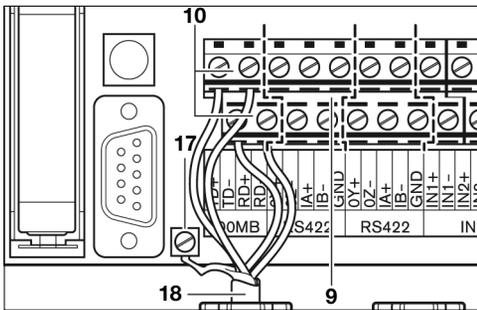
Schneiden Sie an dem Twistedpair-Kabel **18** für Ethernet-Netzwerke einen Stecker ab. Ziehen Sie das Kabel durch die Öffnung des linken Anschlussstutzens **8** zur Klemmleiste **9**.
