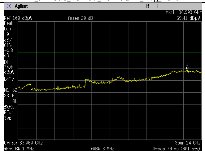
IC_U-NII-1_5200MHz_low_Mid Ch_40_20MHz BW_a-mode_15.209_26-49GHz_Peak_Port 2
