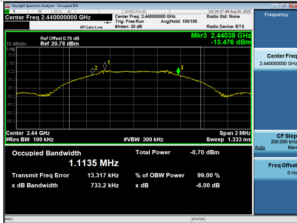
-6dB Bandwidth NVNT BLE 1M 2440MHz Ant1
