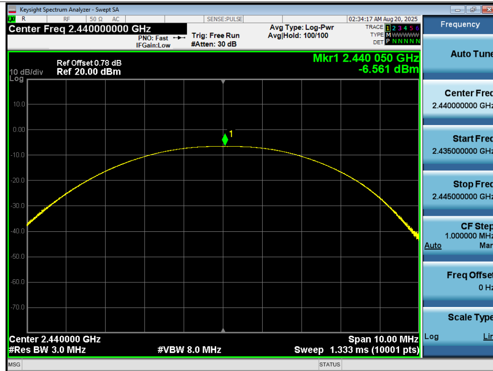
Power NVNT BLE 1M 2440MHz Ant1
