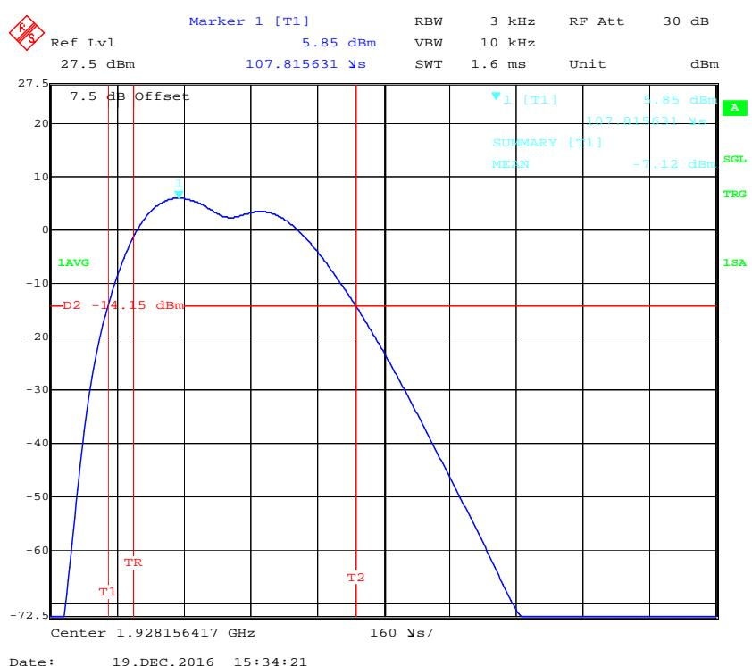
**FCC§15.323 (d) - EMISSION INSIDE AND OUTSIDE THE SUB-BAND****Applicable Standard**
