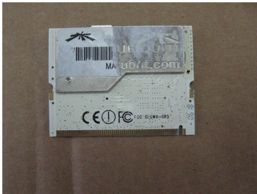
Figure 12 Mini PCI Card Print Side
