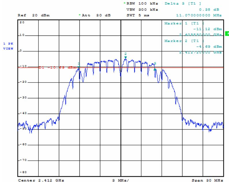
**6dB Band Width: Antenna B CH 2412MHz**
