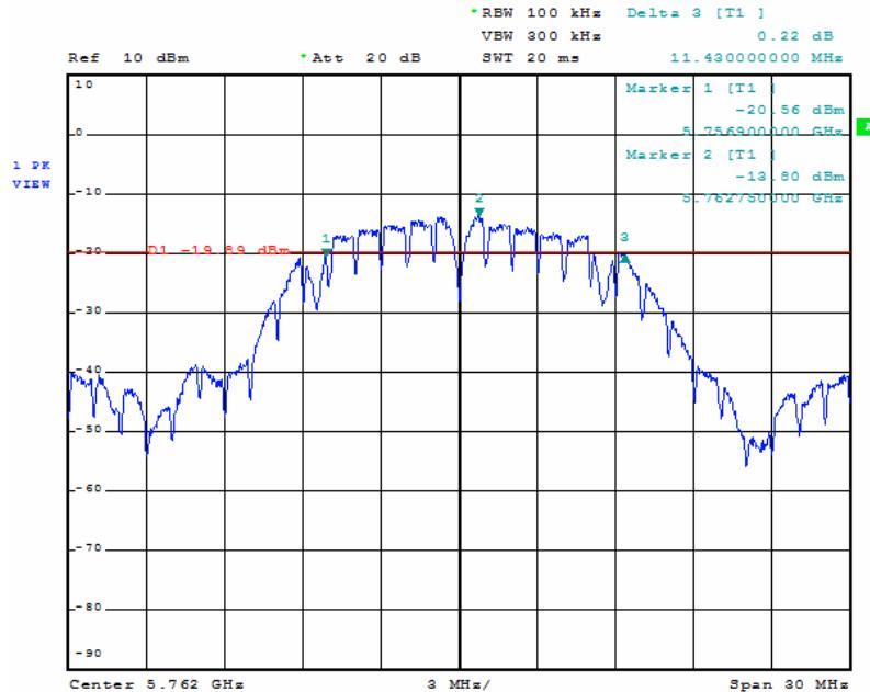
**6dB Band Width Antenna B CH 5762MHz:**
