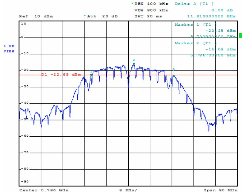
**6dB Band Width Antenna B CH 5736MHz:**
