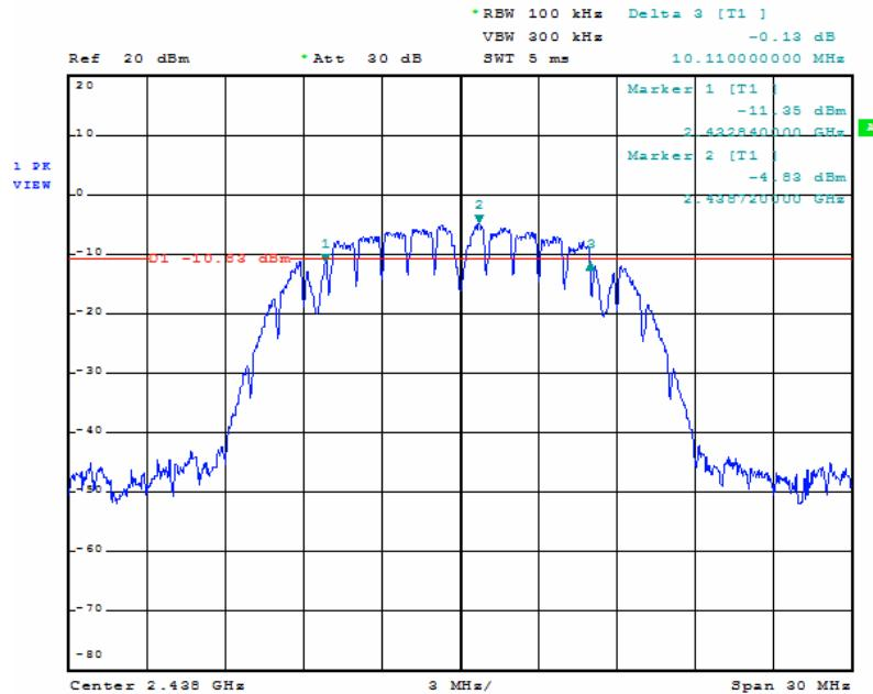
**6dB Band Width Antenna B CH 2438MHz:**
