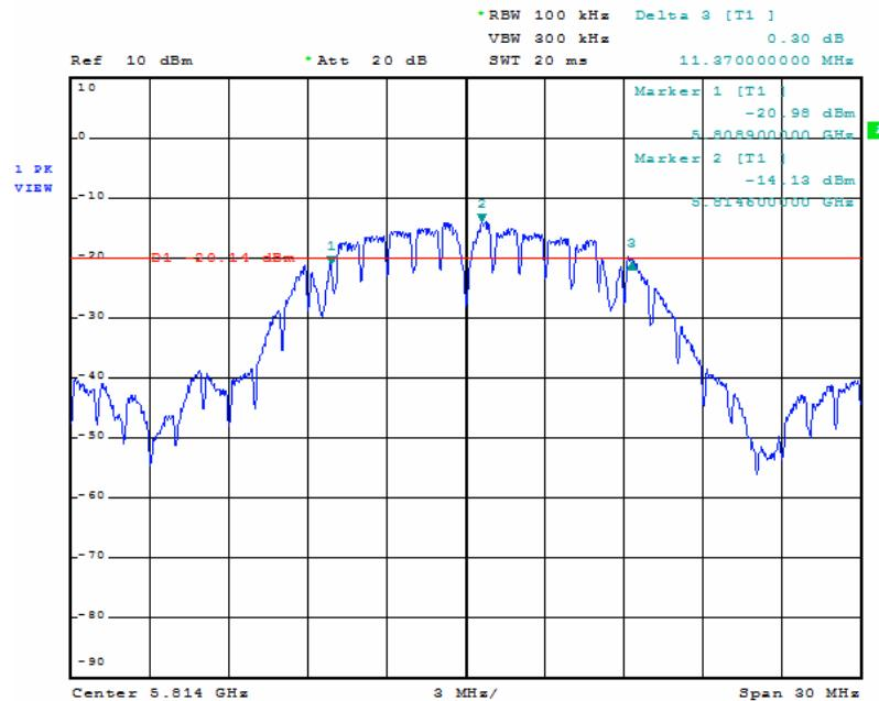
**6dB Band Width Antenna B CH 5814MHz:**
