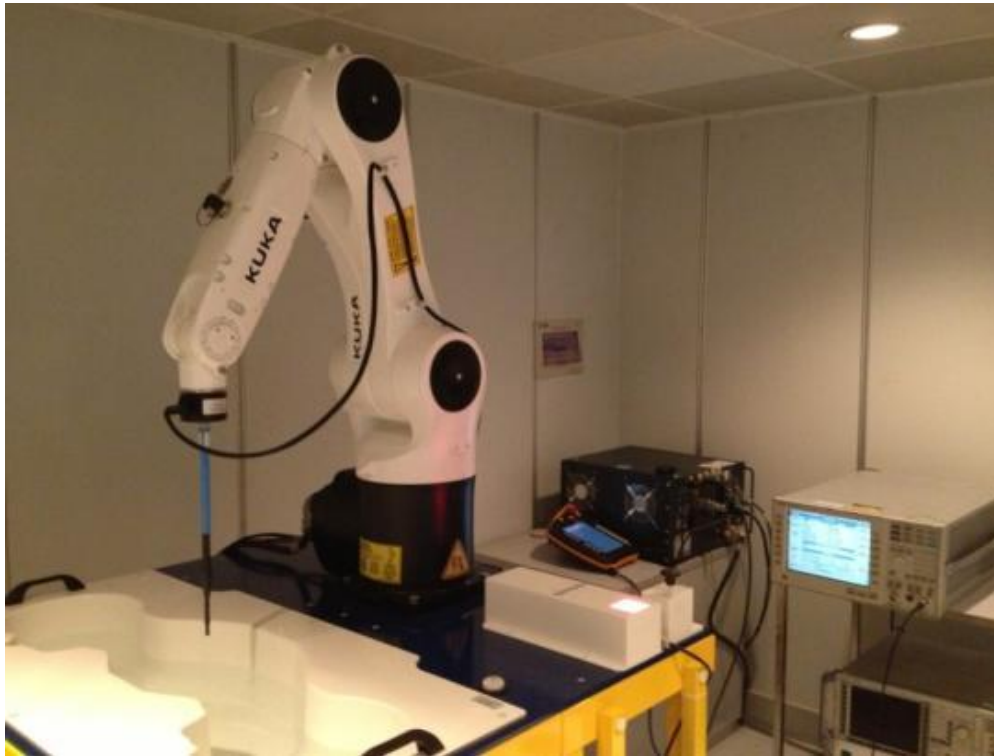
Fig.1 COMO SAR Test System
