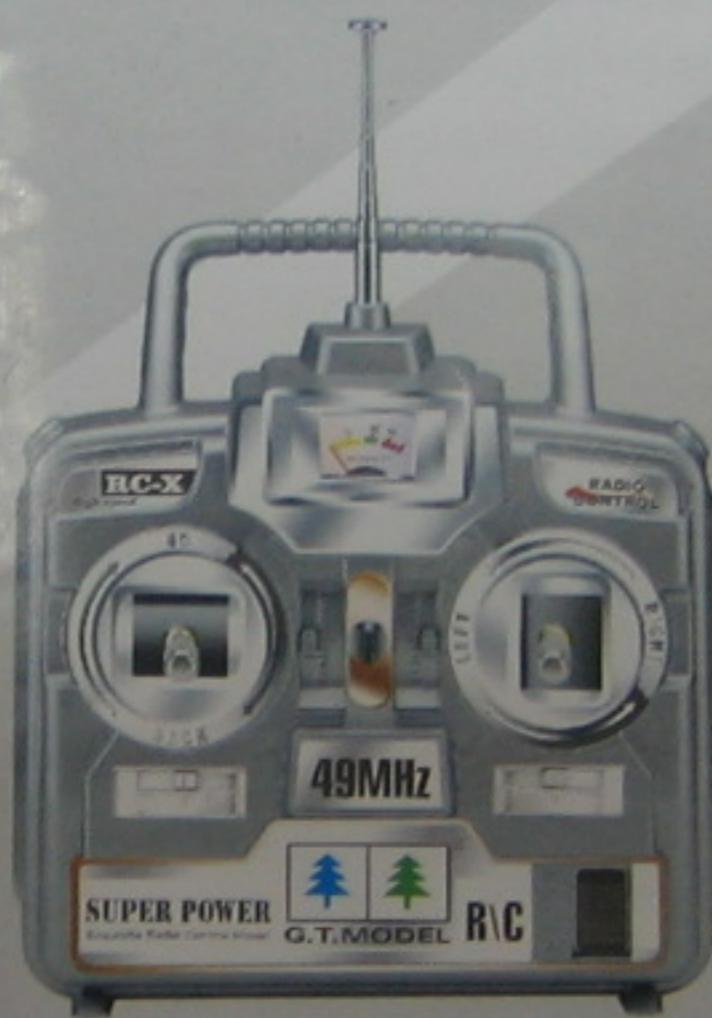
将遥控器扳手向前推为前进，向后推为后退，右边扳手向右扭为右转，向左扭为左转。
