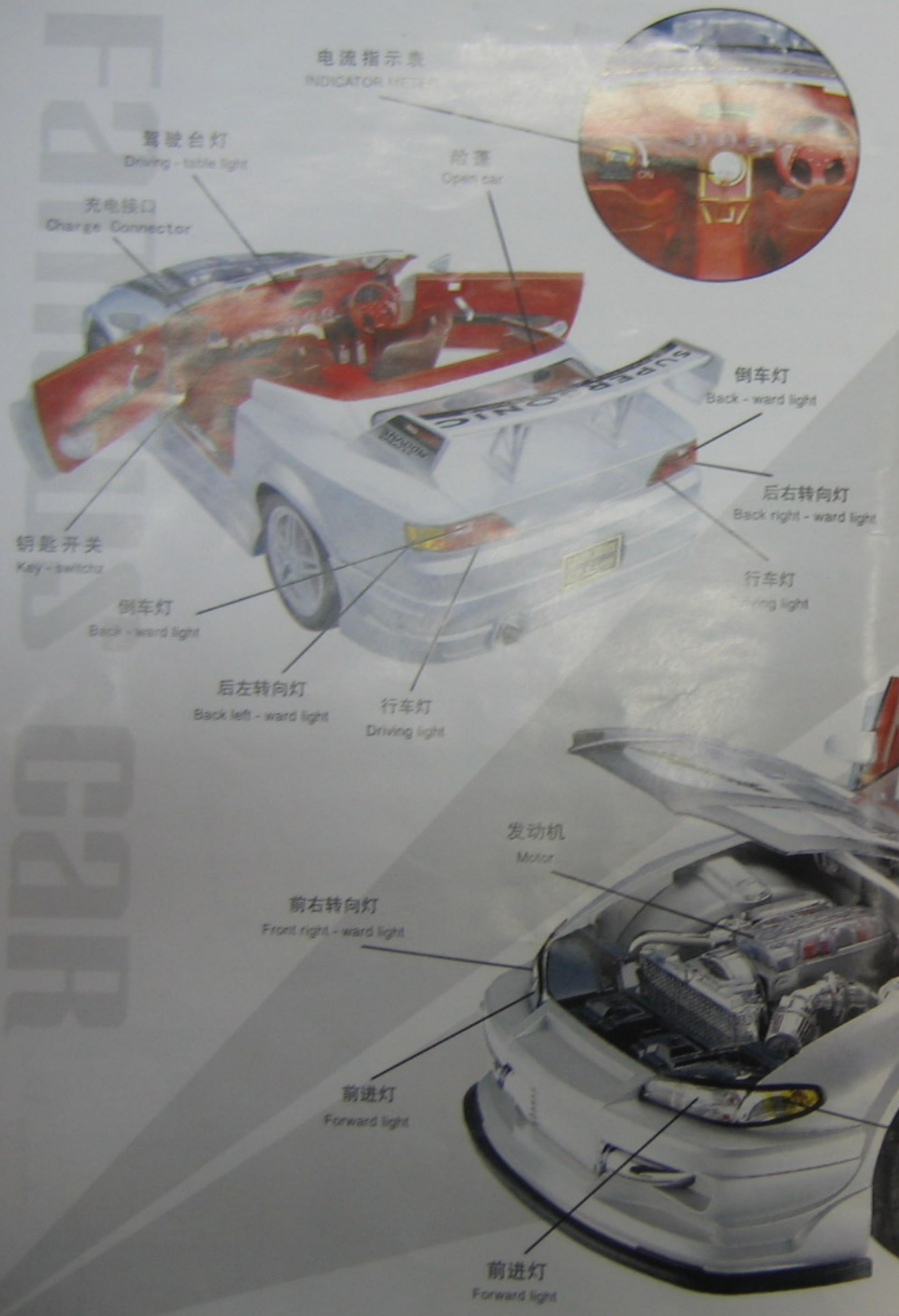
1 将电源开关的钥匙向右转，发动机有工作声音，尾灯亮，驾驶台灯亮，电流指示表亮。
