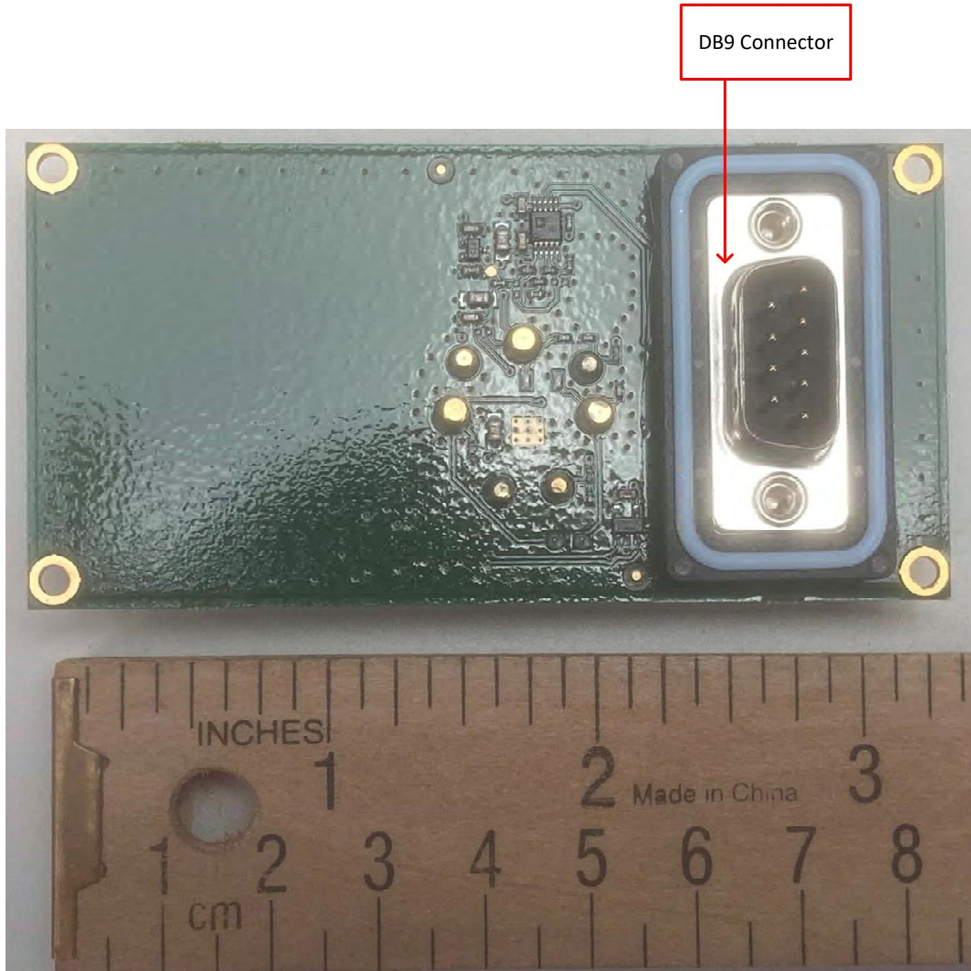
**FAA4913-014 SINGLE GAS SENSOR MODULE (DUAL GAS PCB)-
