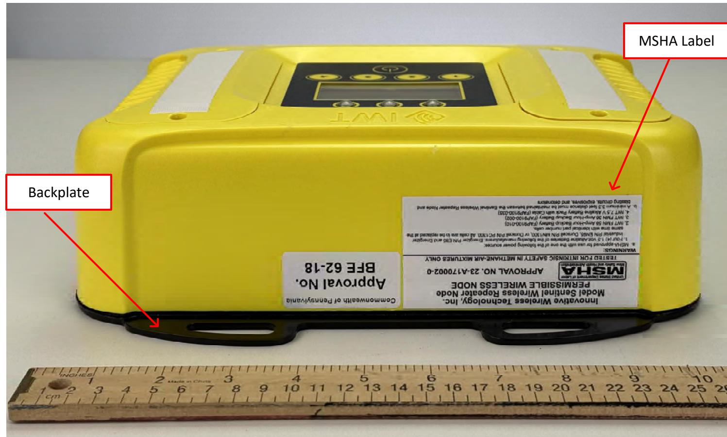
**FAP4213-093 BMN with INTERNAL BATTERIES – LEFT SIDE VIEW**
