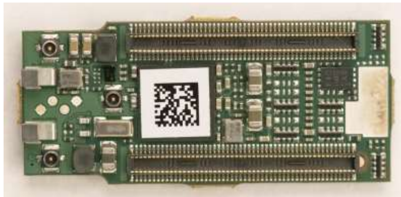
Fig 2.7. ENG 300300-608 SOM Board, Bottom
