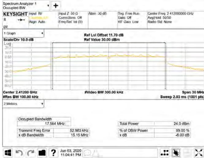
OBW 6dB_802.11n_20MHz_Chain0_2437MHz
