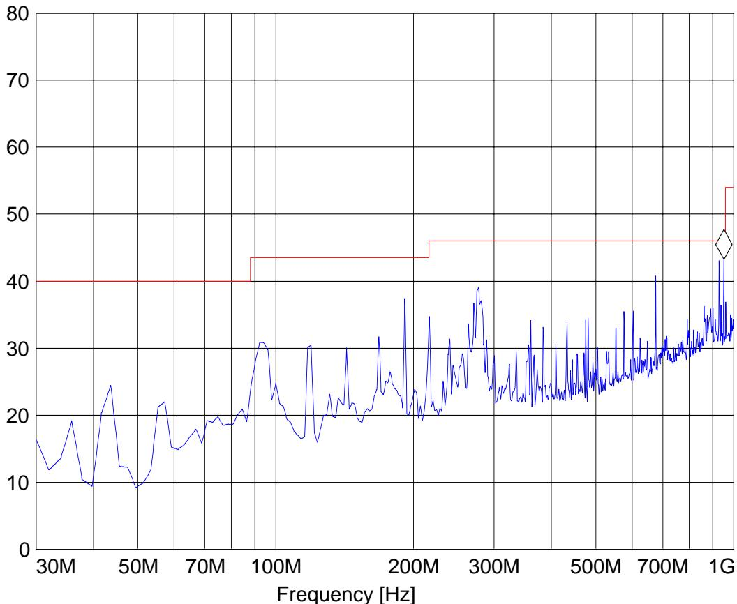
**EMISSION LIMITATIONS - Radiated (Transmitter) §15.247 (d) & RSS-210(A8.5)**
