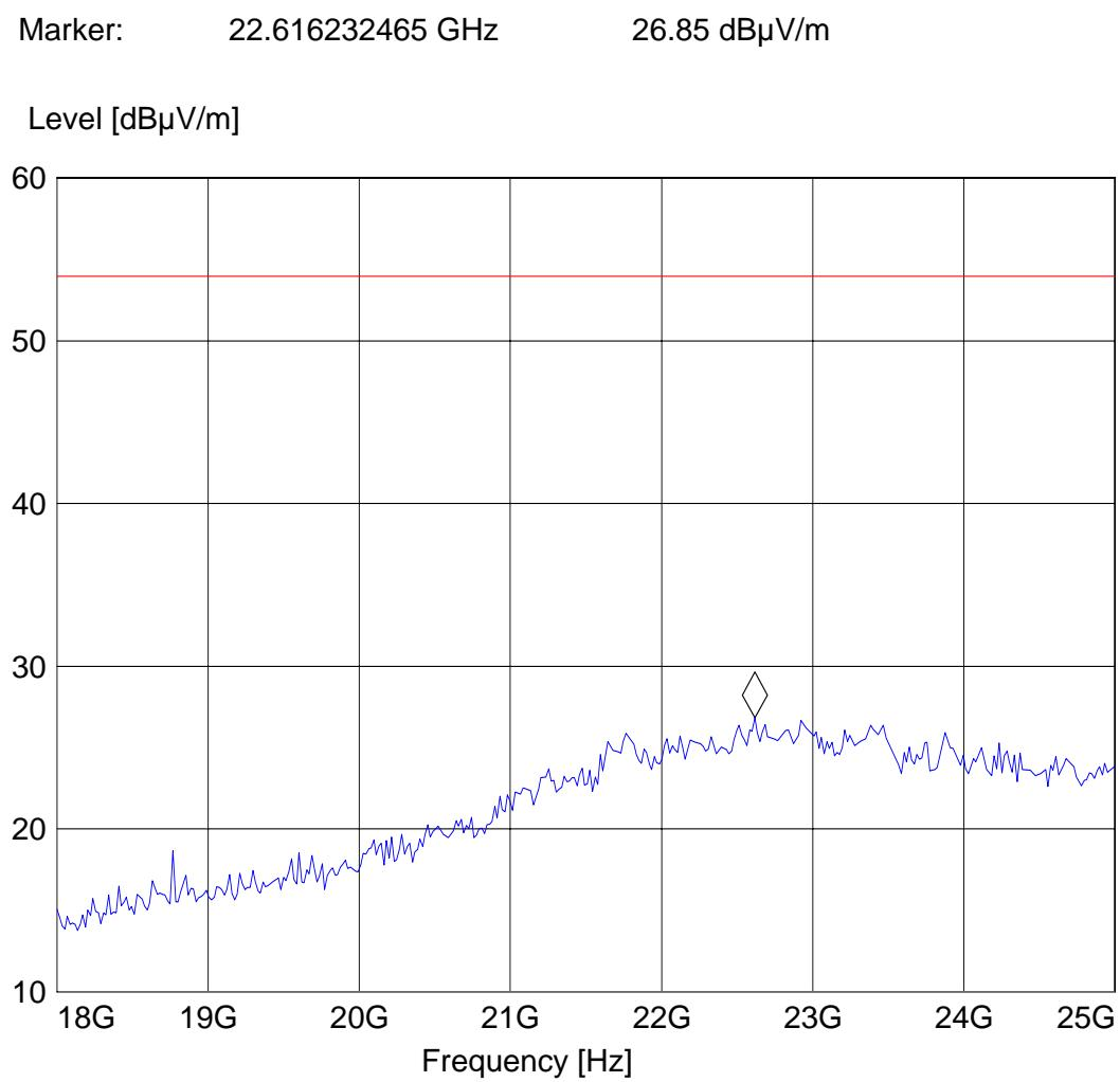
**EMISSION LIMITATIONS - Radiated (Transmitter) §15.247 (d) & RSS-210(A8.5)**
