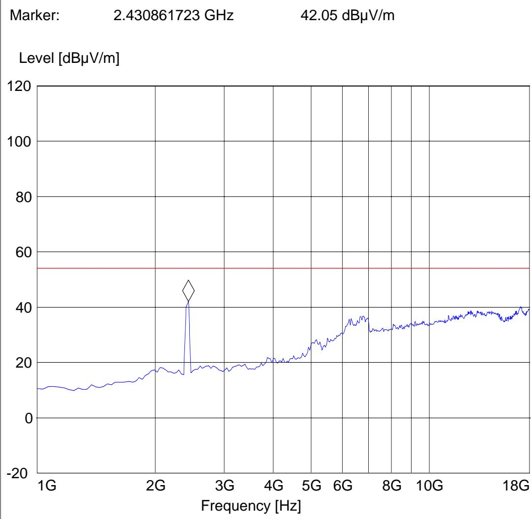
**EMISSION LIMITATIONS - Radiated (Transmitter) §15.247 (d) & RSS-210(A8.5)
