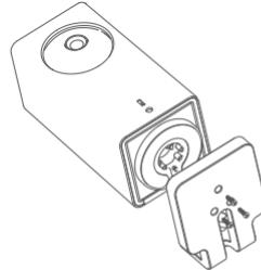
4. Montez le support sur les deux vis déjà installées dans le mur.
