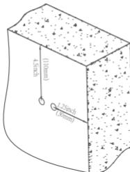
2. Pour les murs de pierres, de briques ou les cloisons sèches, insérez un dispositif d'ancrage au mur (inclus) dans chaque trou. N'utilisez pas de dispositifs d'ancrage au mur si le mur n'est pas de pierres, de briques ou une cloison sèche. Vissez les vis les plus longues dans les trous existants ou les dispositifs d'ancrage au mur. Laissez chaque vis dépasser de 5,0 mm/0,21 pouce du mur.
