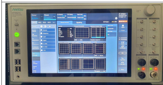
4G, LTE Cat.M, NB-IoT : Anritsu MT8821C
