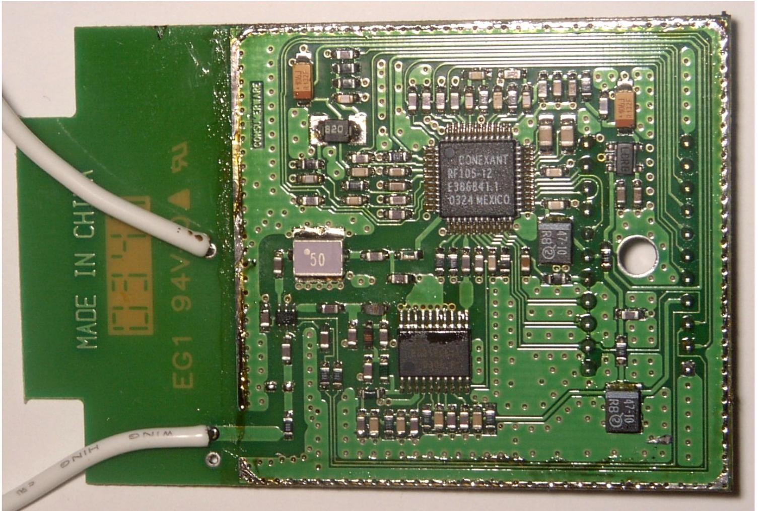
BASE RADIO PCB COMPONENT SIDE
