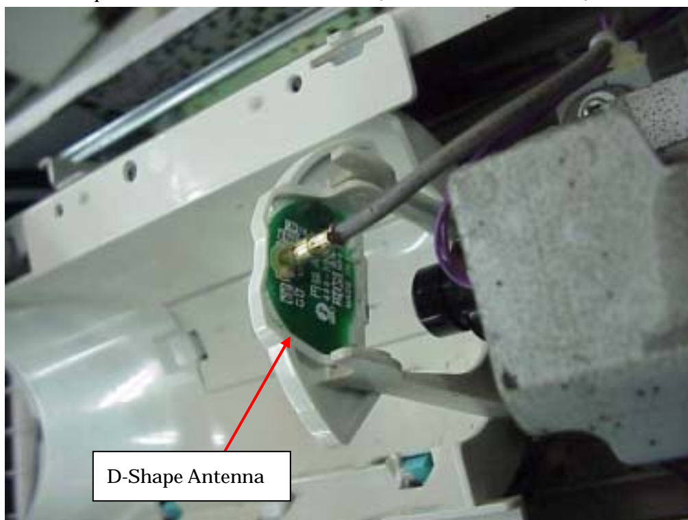
写真6 D-Shape Antenna の取り付け状態 (上部写真の上から撮影)
