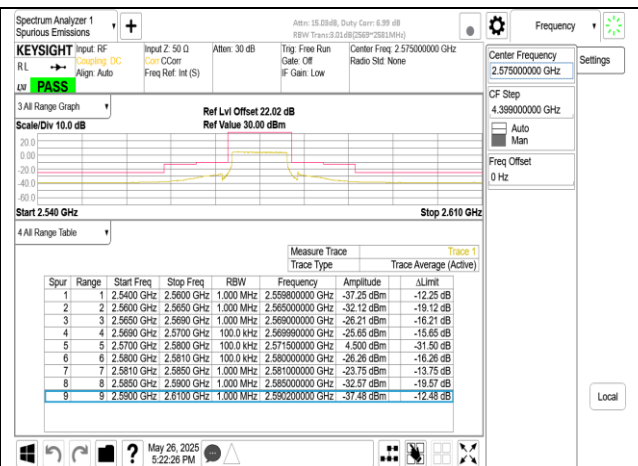
Band38 10MHz CP OFDM SCS30kHz QPSK RB24 0 CH515000
