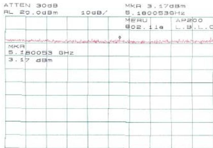
CENTER 5.180000GHz SPAN 1.000MHz
