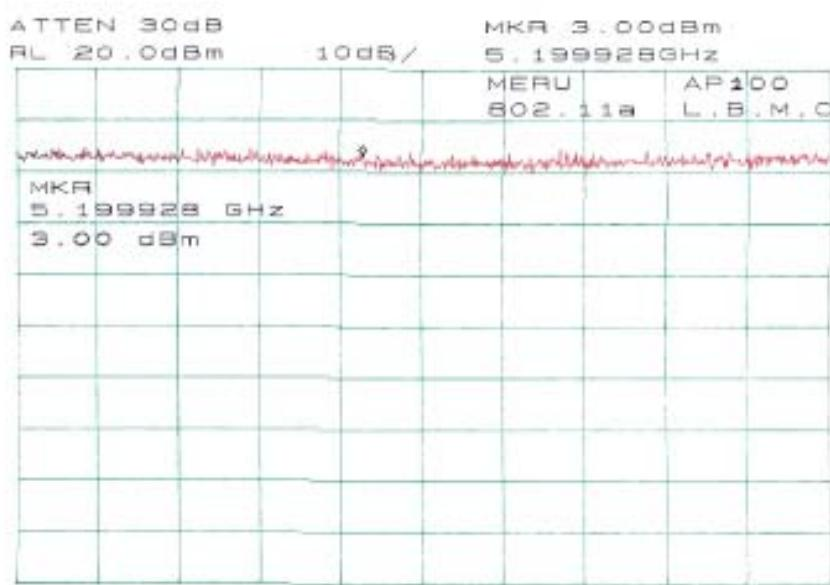
CENTER 5.200000GHz SPAN 1.000MHz
