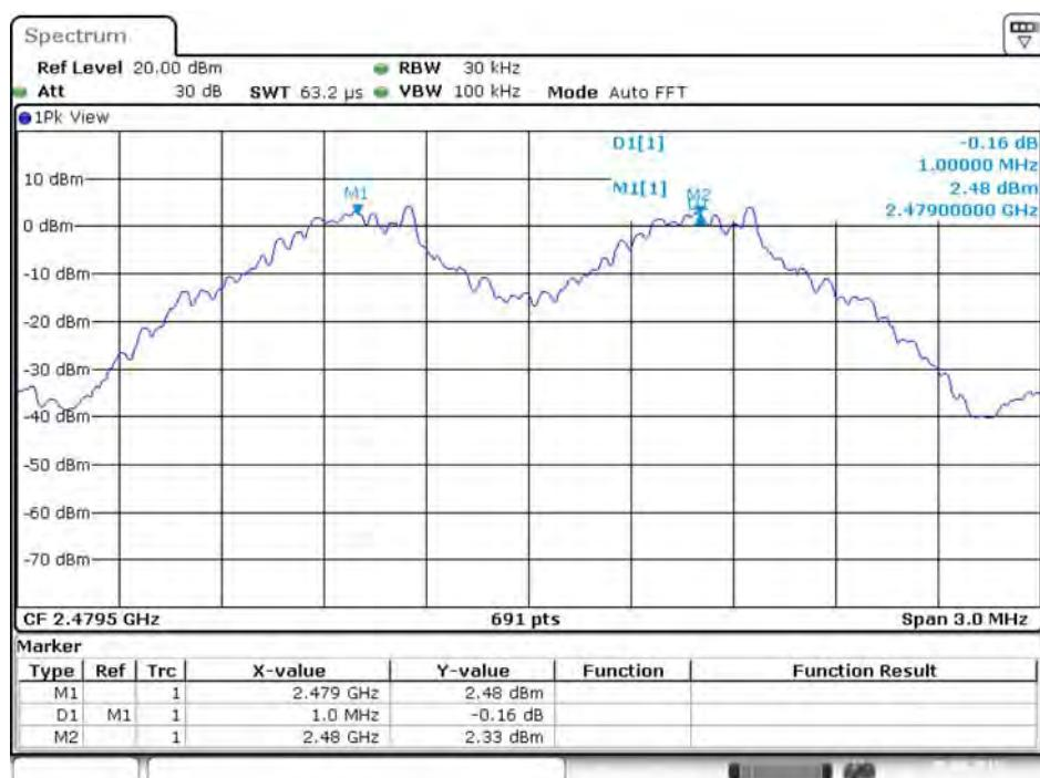
**20 dB Bandwidth Plot on EDR ( $\pi/4$ -DQPSK) 2 Mbps / Channel 0 / 2402 MHz**
