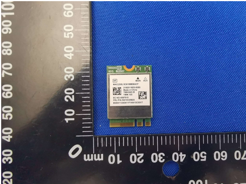
RF MODULE TOP VIEW-MT7921
