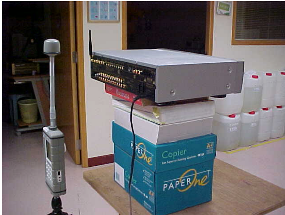
Maximum Permissible Exposure Measurement Test Setup – AV Unit
