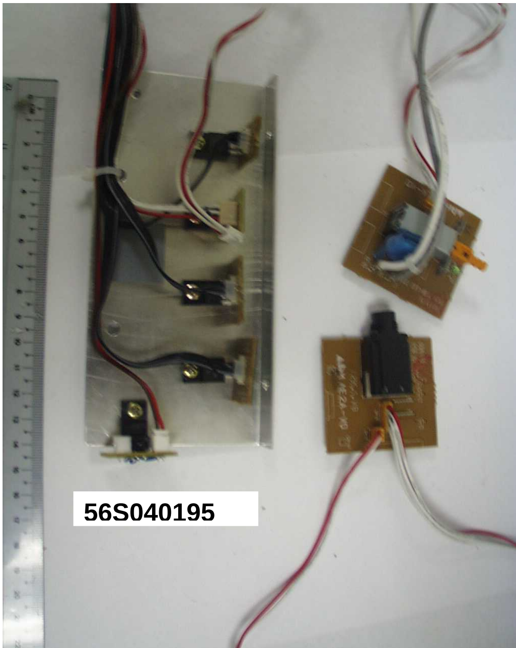
AV Unit – Power Supply Sub-Board Component Side
