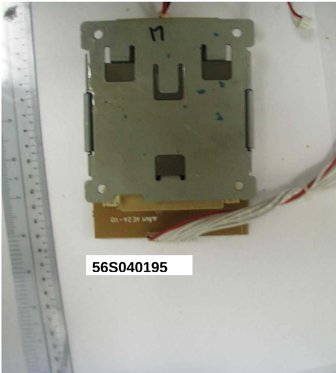
AV Unit – Power Transformer Board View 2
