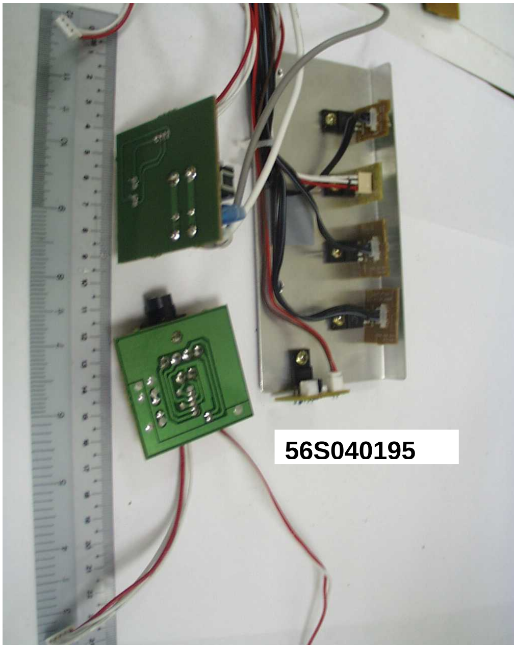
AV Unit – Power Supply Sub-Board Trace Side
