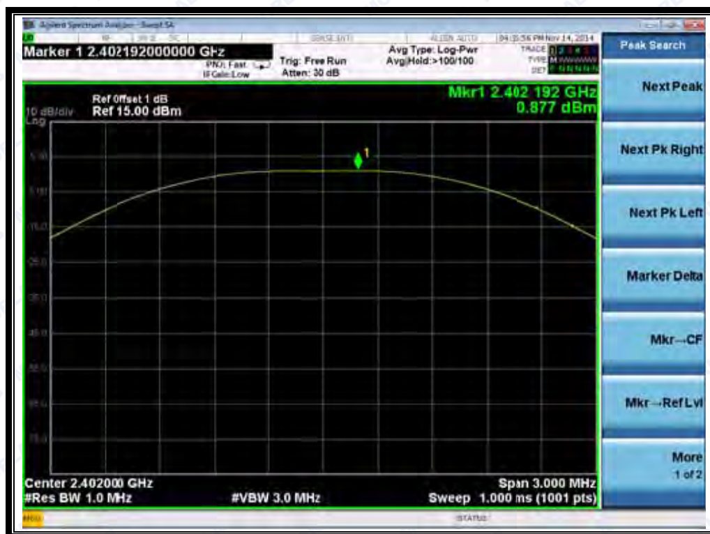
(Plot A: Channel 0: 2402MHz)
