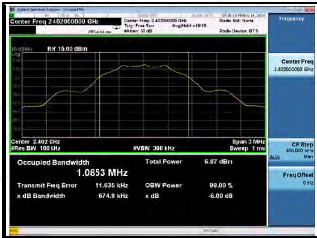
(Plot A: Channel 0: 2402MHz)
