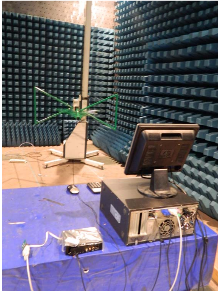
Wi-Fi test, 30MHz-1000MHz
