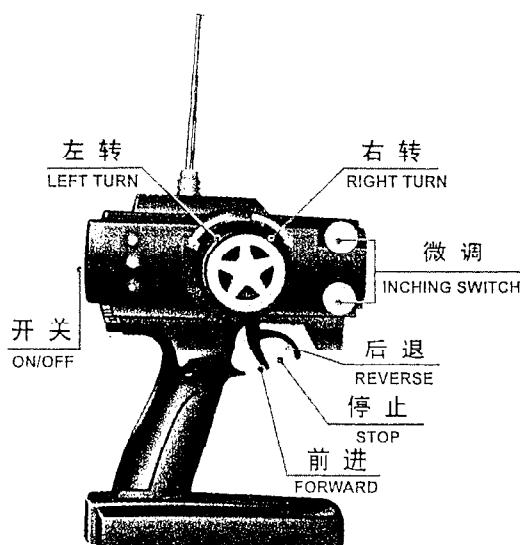
将遥控器扳手向下拨为前进，上推为后退，侧面手轮向左扭为左转向，向右扭为右转向，前进后退左右转向完全实现无级调速。
