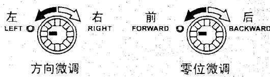
随着电池电压变化，可以利用微调旋扭随时重新调整零位。
