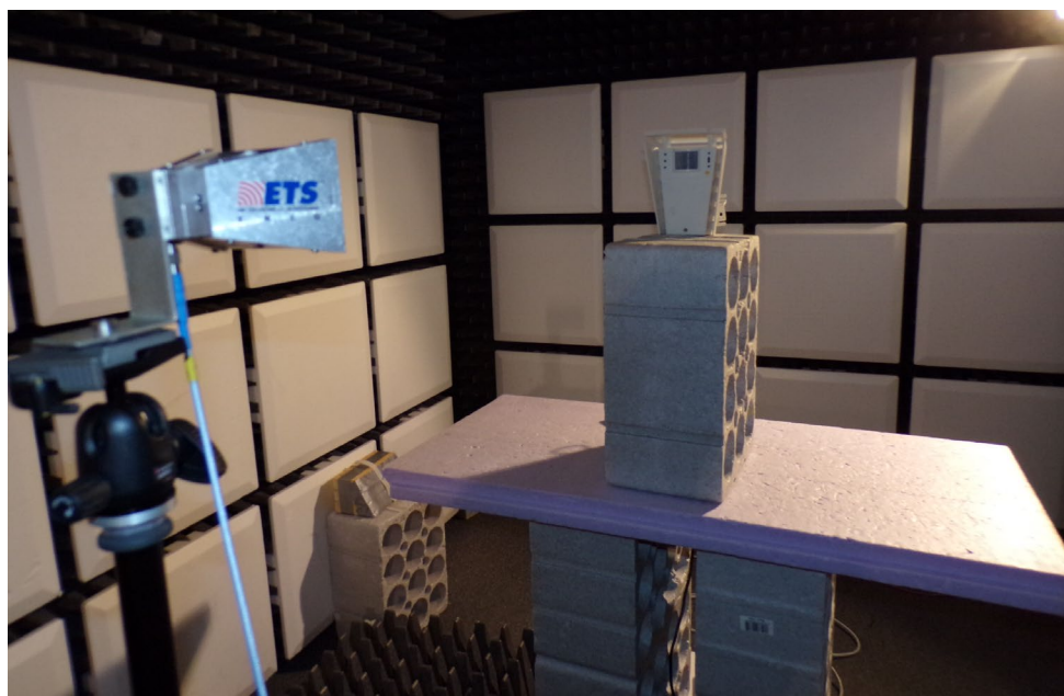
FAC setup (18GHz-25GHz / 1m)
