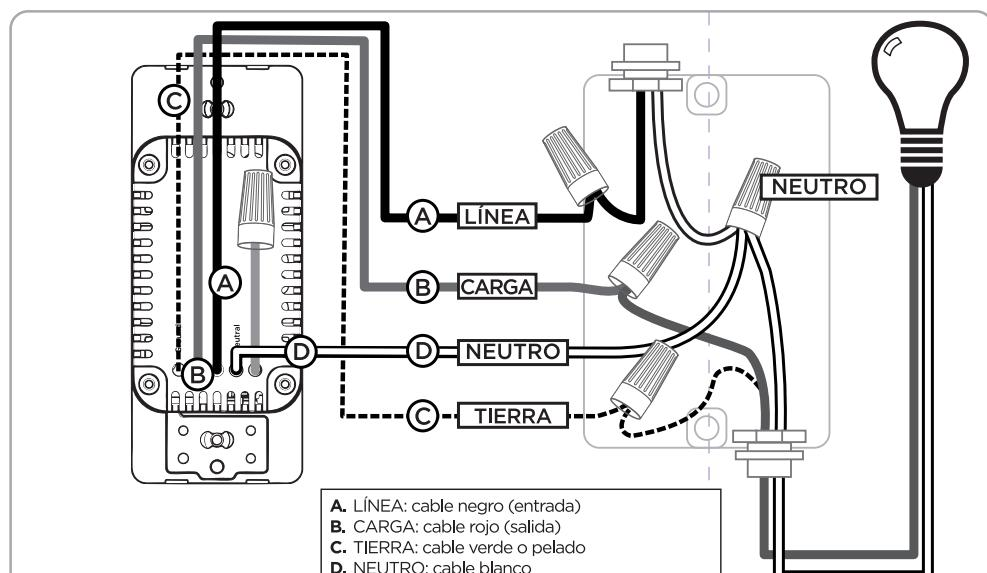
1. Conecte el cable verde/pelado al conductor de TIERRA (GROUND)
