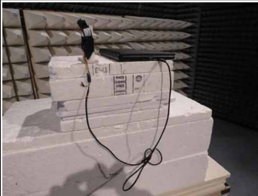
EUT Test Setup (EUT vertical)
