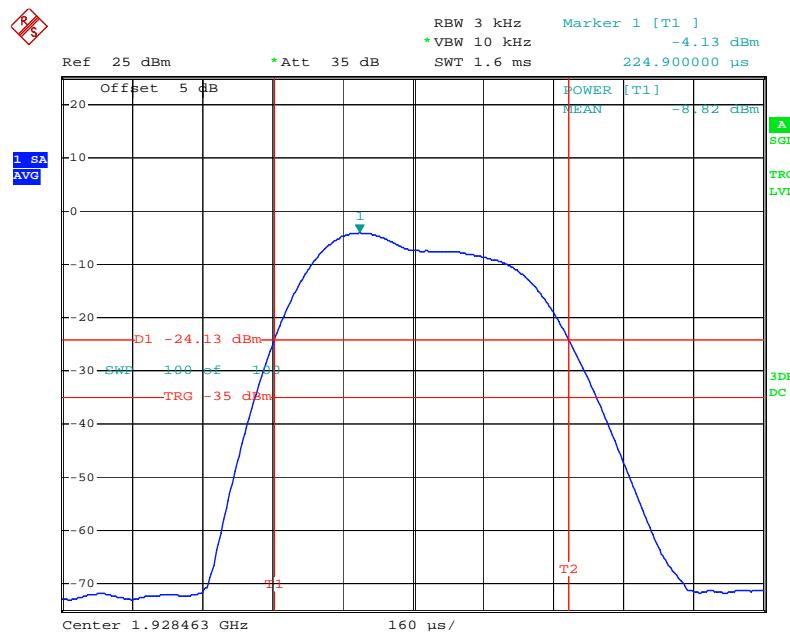
**FCC §15.323 (d) - EMISSION INSIDE AND OUTSIDE THE SUB-BAND****Applicable Standard**
