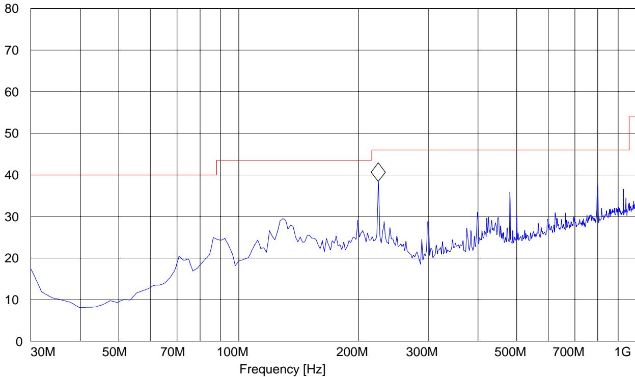
**EMISSION LIMITATIONS - Radiated (Transmitter) §15.247 (d) & RSS-210(A8.5)**
