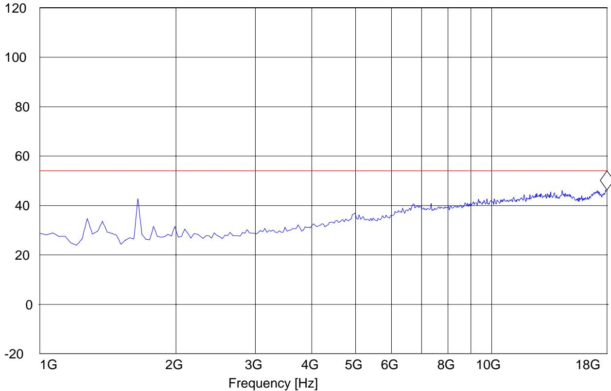
**EMISSION LIMITATIONS - Radiated (Transmitter) §15.247 (d) & RSS-210(A8.5)**
