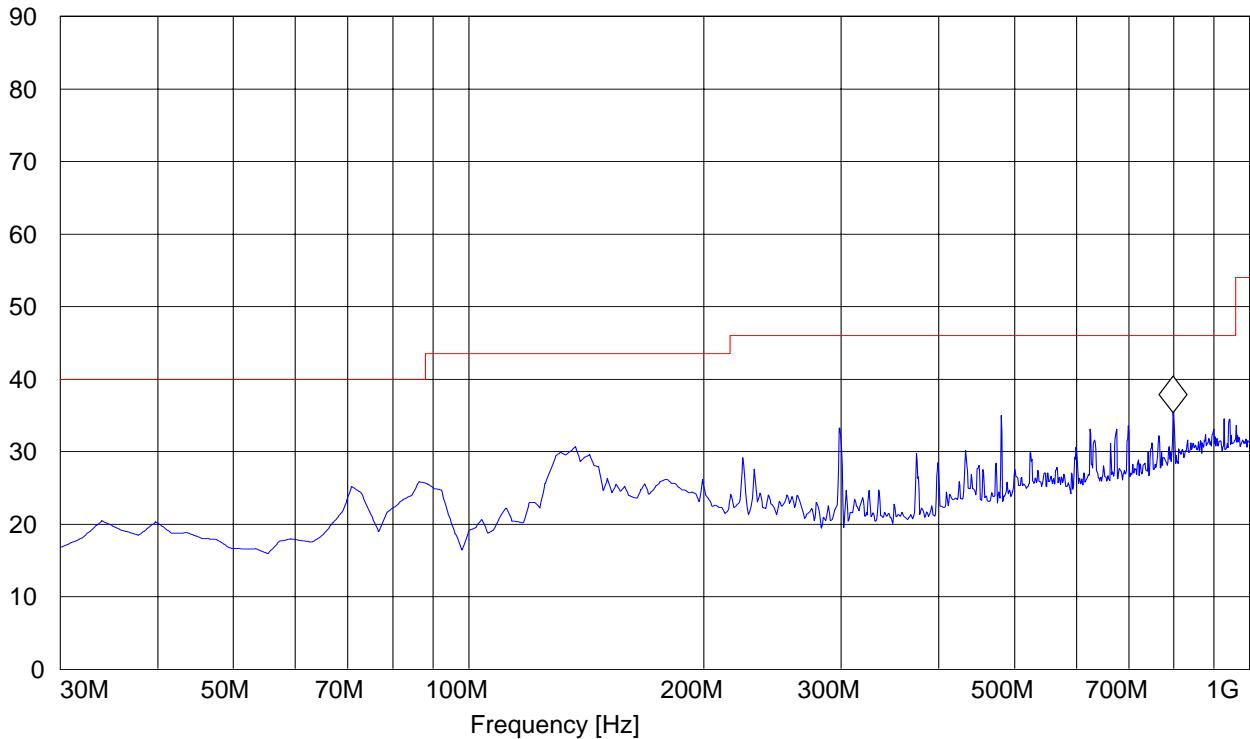
**EMISSION LIMITATIONS - Radiated (Transmitter) §15.247 (d) & RSS-210(A8.5)**
